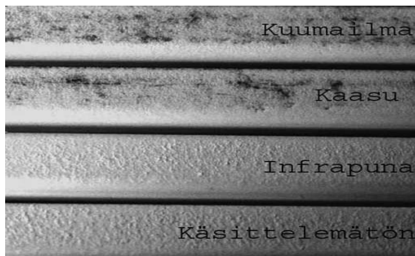
KUVIO 25. Pintakäsitellyt testikappaleet (kuva 4/4)
