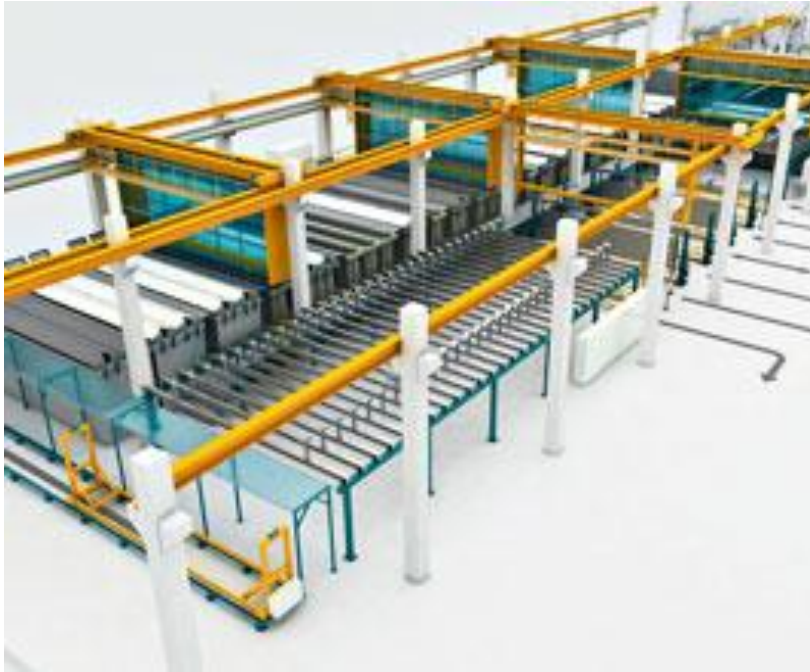
Kuvio 3. Tietokonemallinnus valmiin anodisointihallin sisätiloista. (Repo 2011.)
