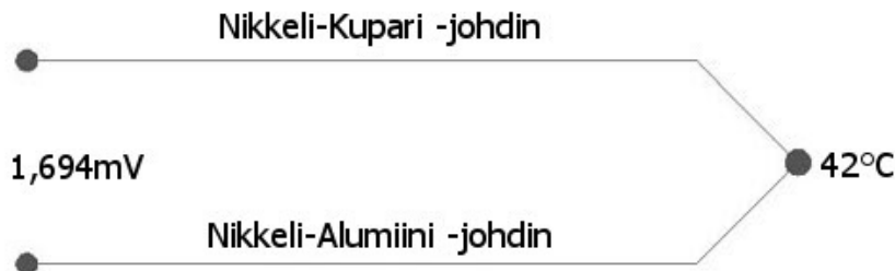
Kuva 8. Termoelementin toimintaperiaate (K-tyyppi)
