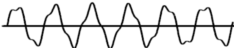
Kuva 8. Epäharmonisten yliaaltojen säröyttämä jännite [4, s. 4]
