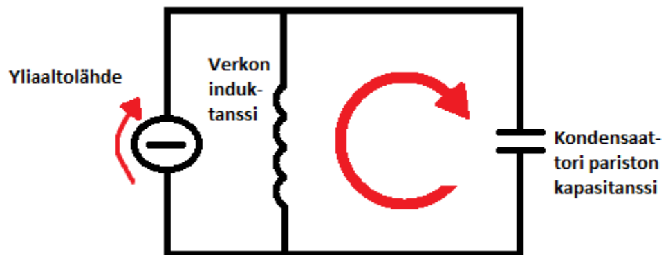
Kuva 13. Resonanssitilanteen sijaiskytkentä [8, s. 65 lähdettä mukaillen]
