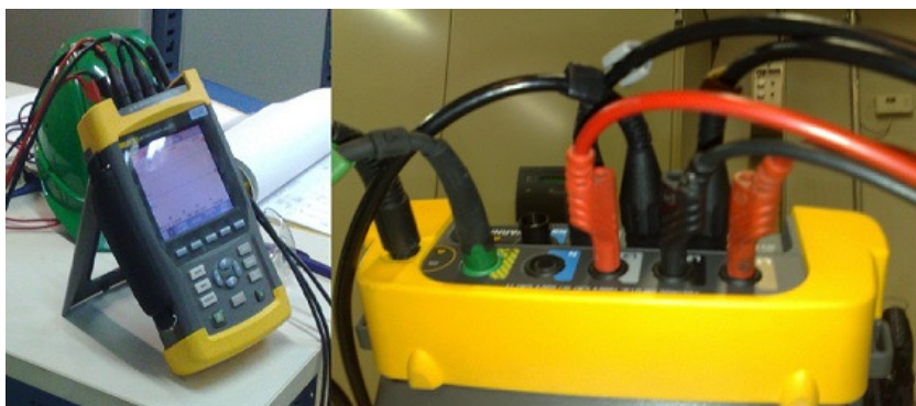
Kuva 20. Fluke 435-sähkönlaadun mittari
