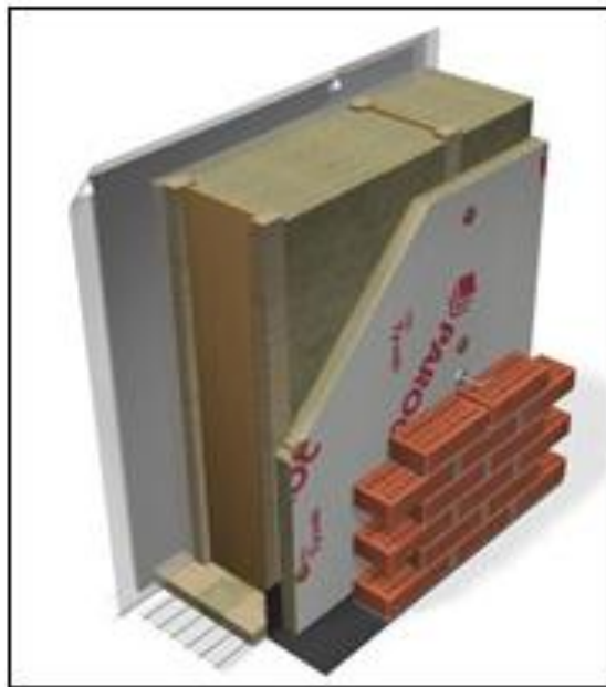
Kuva 4. Passiivitalon puurakenteinen I-palkkirunko /10/.
