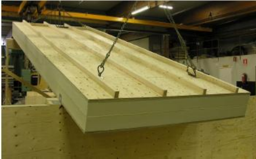
Kuva 6. SPU Systems Oy:n patentoima passiivikattorakenne /12/.
