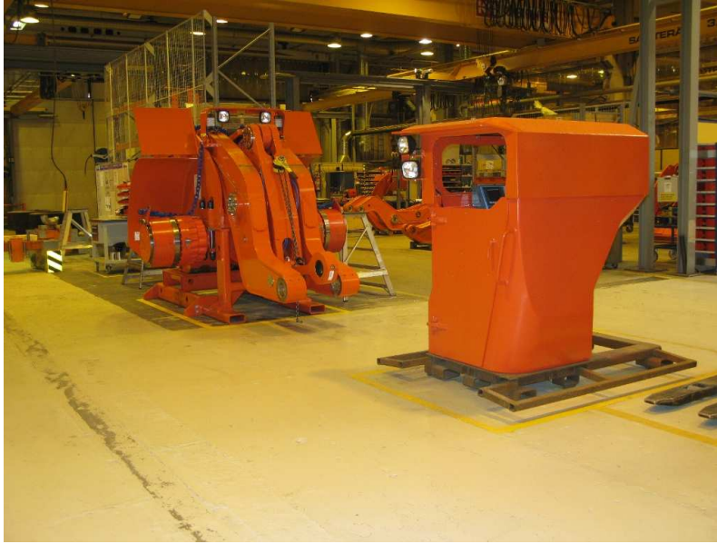
Kuva 5. Osakokoonpanoja valmiina asennukseen asemalla neljä.
