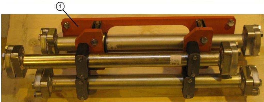
Kuva 7. Taustalevy (1), joka mahdollistaa voimansiirron imuputkien esikokoonpanon.
