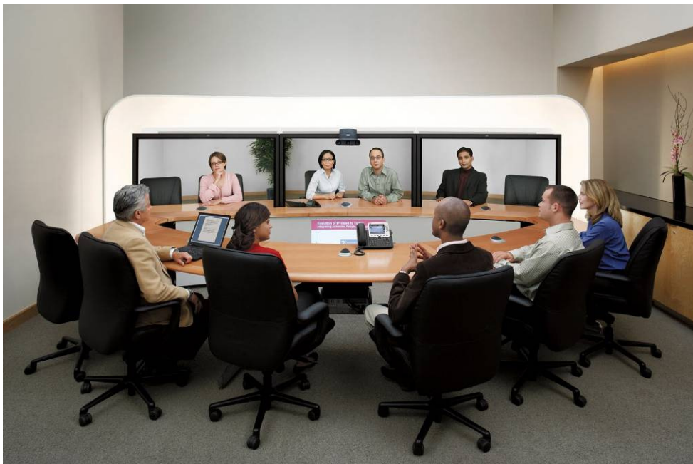
Kuva 5. Kolmen näytön telepresence-laitteisto
