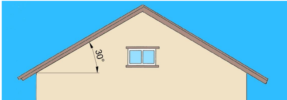
KUVIO 57. Esimerkki likimääräisestä kattokaltevuudesta
