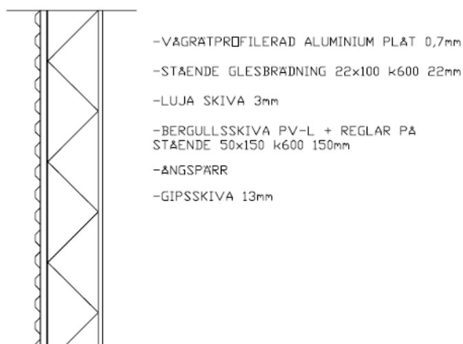
Figur 22. Skärning av yttervägg 1.
