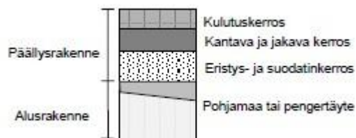
KUVA 14. Tien osat (Metsäteho Oy 2011, 2)
