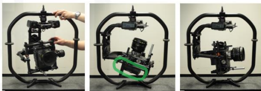
Kuva 1: Pidä kameraa suorassa. Kuva 2: Kamera kallistuu ylöspäin. Kameran peräosa on painavampi. Kuva 3: Kamera on tasapainossa.
