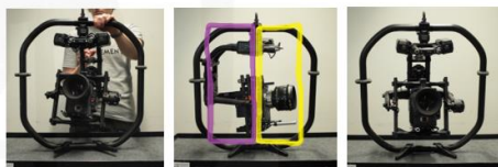
Kuva 1: Käännä gimbaalin varsi sivulle 45° kulmaan ja päästä irti Kuva 2: Gimbaalipuoli ja kamerapuoli: kuvassa gimbaalin varsi on painavampi. Kuva 3: Kamera on tasapainossa, kun se ei kallistu sivulle eikä keskelle.
