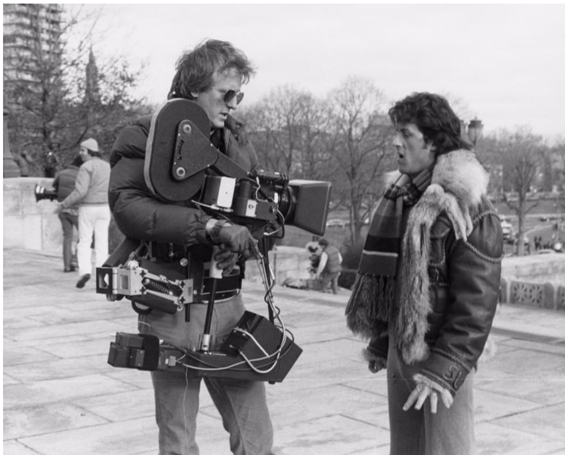
KUVA 1: Brownin ensimmäistä elokuvauskäytössä olevaa Steadicamia on kehitetty ominaisuuksiltaan, mutta teoriassa uusimmat Steadicamit toimivat samalla tavalla edelleen. (British Cinematographer f.a.)
