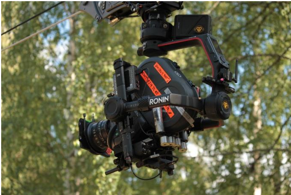
KUVA 8: Vaijerikamerakuvissa (eng. cable cam) tarvitaan aina avuksi gimbaali, tässä tapauksessa Ronin 2. (Karvinen 2019)
