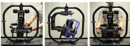
Kuva 1: Aseta kamera osoittamaan ylöspäin. Kuva 2: Kamera kallistuu pohja edellä. Kameran pohjaosa on painavampi. Kuva 3: Kamera on tasapainossa, kun se ei enää kallistu kumpaankaan suuntaan.
