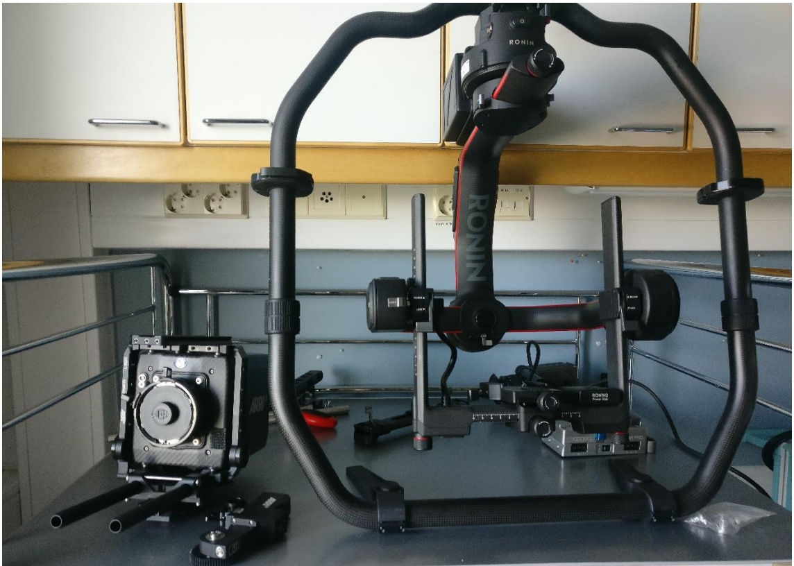
KUVA 10: Kamerasta kannattaa poistaa luoppi, kahva, alaosite putkineen ja akkukenkä ennen gimbaalin sovitteiden kiinnittämistä. (Karvinen 2017)
