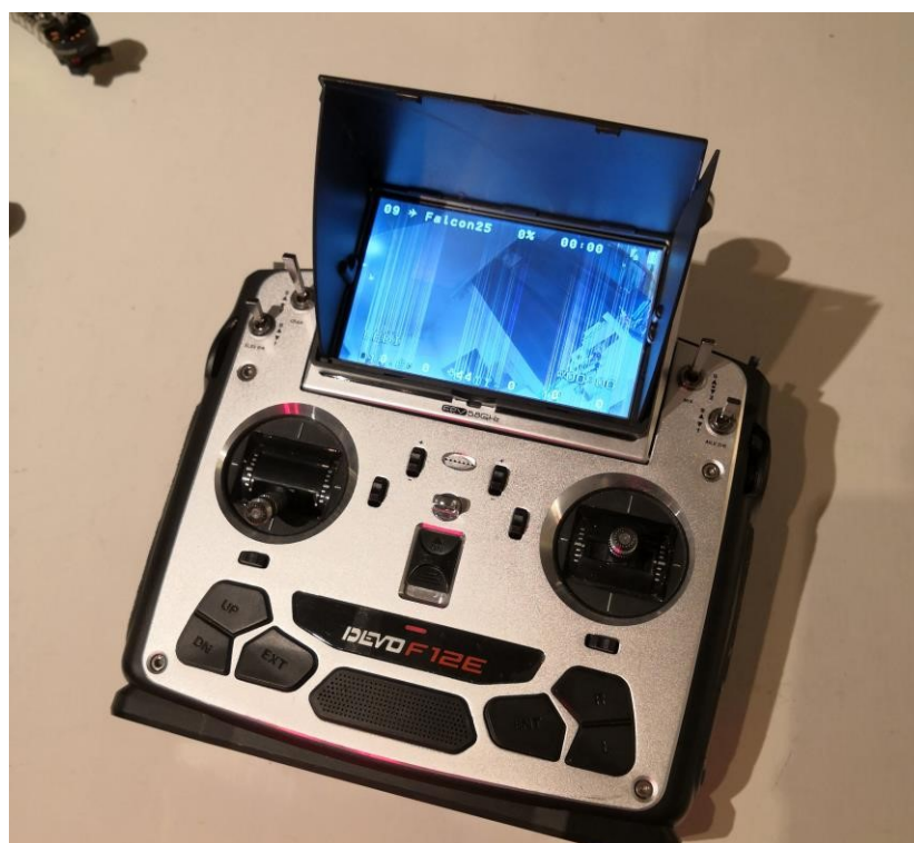
Kuva 13 Kopterin kanssa käytettävä ohjain sekä siihen integroitu näyttö.
