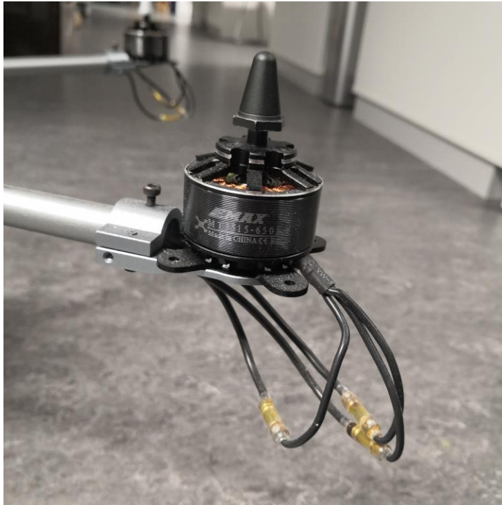
Kuva 7 Moottori ja sen alla roikkuvat tarpeettoman pitkät johdot.
