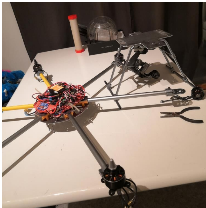
Kuva 6 Koptein yläosa ja jalakset erotettuina toisistaan.
