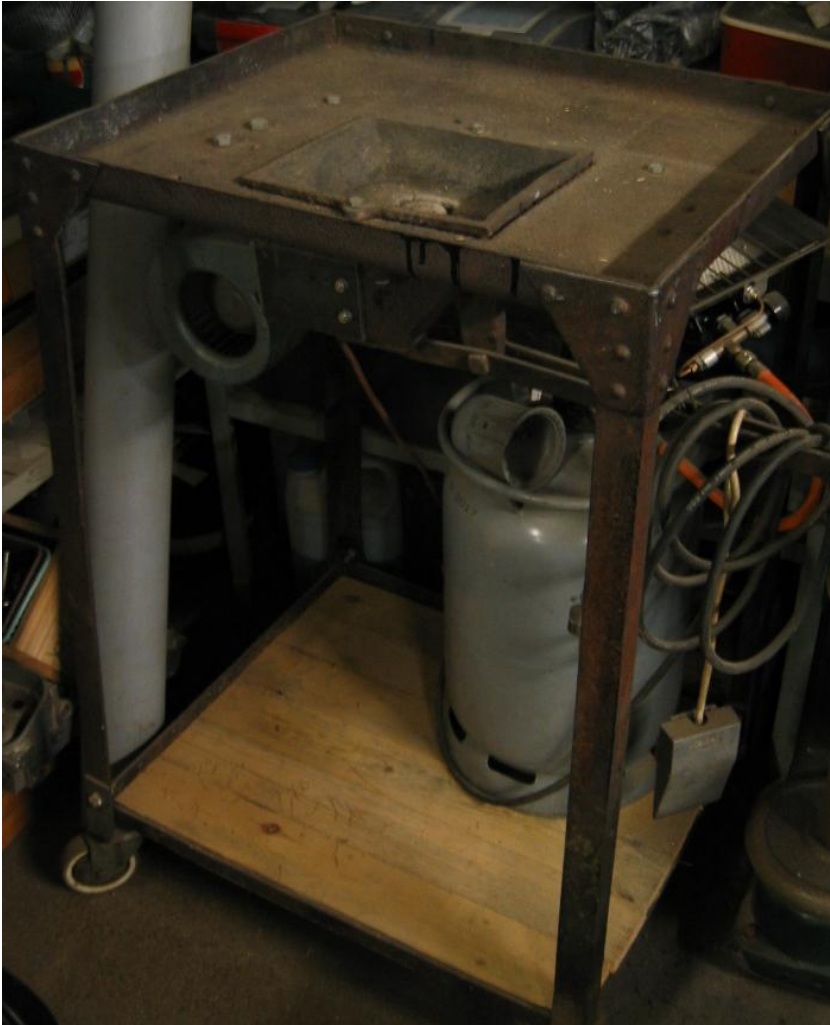
Kuva 16. Ahjo: Ahjon on aluksi jo valmiiksi hankittu, pyörillä liikutettava ja sähköllä puhallettava kevyt malli, mutta suurempaa käyttöä ajatellen pitää todennäköisesti ahjon olla hieman isompi ja kiinteä, varsinkin jos tuotantomäärät kasvavat. [18]
