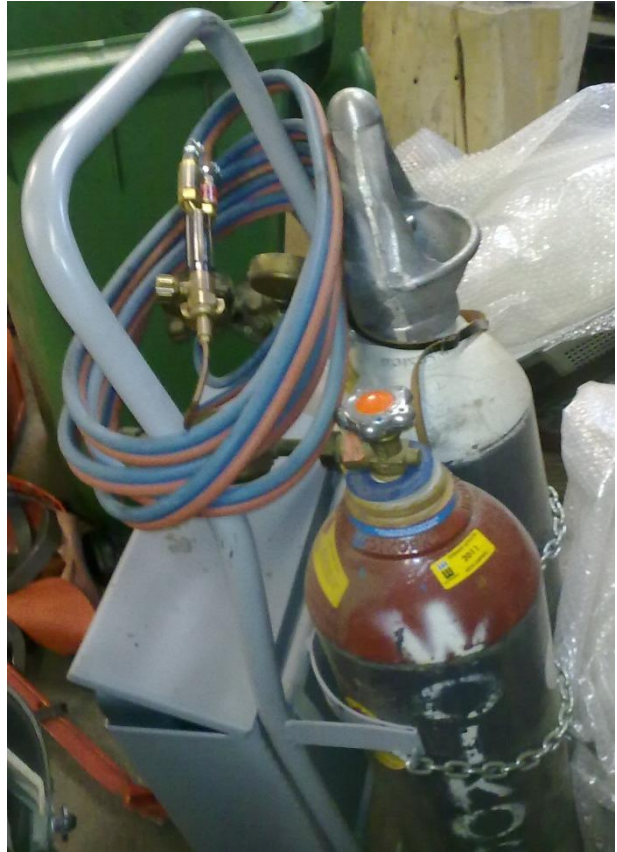
Kuva 5. Kaasuhitsauslaitteisto on helposti liikuteltavissa kaikkine tarvikkeineen, koska sitä tarvitaan niin purku- kuin kokoonpanon puolella. [18]
