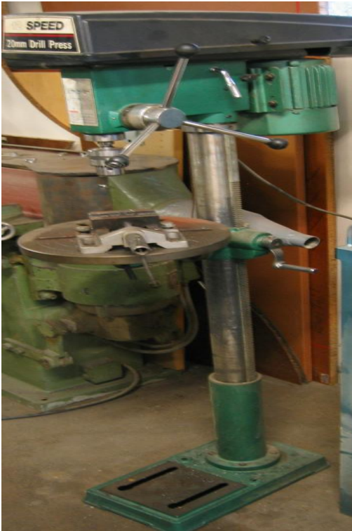
Kuva 8. Pylväsporakone: vanha, hihnavetoinen ja verkkovirralla toimiva pylväsporakone, jolla pystyy tekemään pienen mittakaavan porauksia. Töiden lisääntyessä suurempi ja vahvempi porakone tulee hankintaan, joskin suurimmat poraukset tehdään joka tapauksessa sorvissa. [18]
