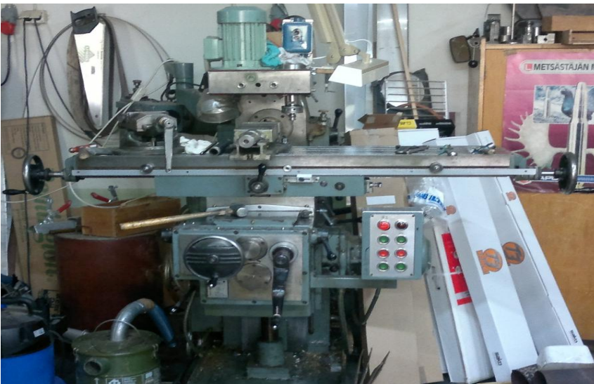
Kuva 7. Jyrsinkone: pienikokoinen, vanha, voimavirralla toimiva käsikäyttöinen jyrsinkone jolla pystyy tekemään pieniä koneistuksia. Vanhasta iästään huolimatta laite on uudenveroinen ja luotettava. [14]
