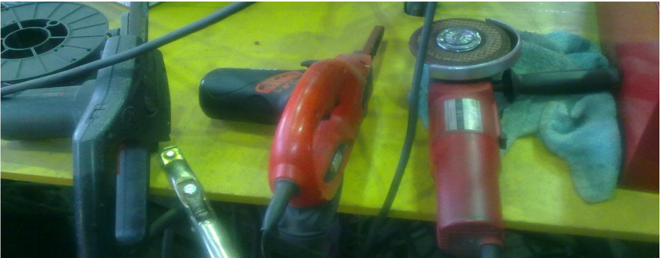
Kuva 24. Muut jälkikäsittelyn laitteet tulevat pöydän alatasolle ruuvipenkin läheisyyteen. Kuvassa on esimerkkeinä pienet nauhahiomakoneet ja pieni kulmahiomakone. [15]
