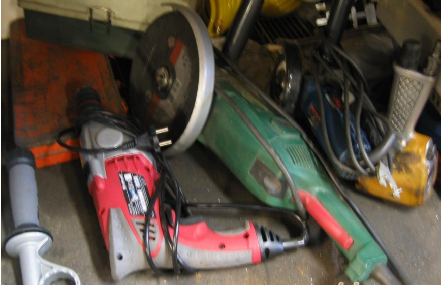
Kuva 14. Muut pienlaitteet: mm. kulmahiomakone (iso + pieni), paineilmatyökalut (esim. pyöröjyr- sin, naulain, nitoja), porakoneet, akkuporakoneet, pieni nauhahiomakone, peltileikkuri, jne. Nämä tullaan säilyttämään pöydän alla olevalla tasolla kuten kuvan tilassakin. [18]
