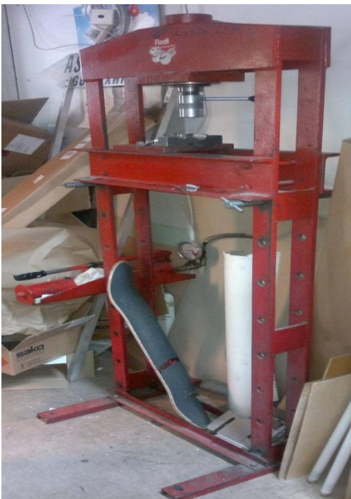
Kuva 9. Hydraulikäyttöinen taivutin: pieni taivutin, joka on käsin pumpattava. (Rullalauta on kuvassa mittakaavan osoittamiseksi.) [14]
