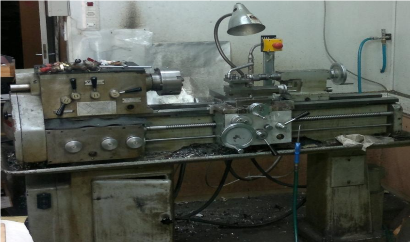
Kuva 6. Sorvi: pienikokoinen, vanha, voimavirralla toimiva käsikäyttöinen sorvi jolla pystyy tekemään pieniä sorvaustöitä. Hyvin huollettuna se on hyvässä kunnossa ja soveltuu edelleen tarkkoihin sorvauksiin. [14]
