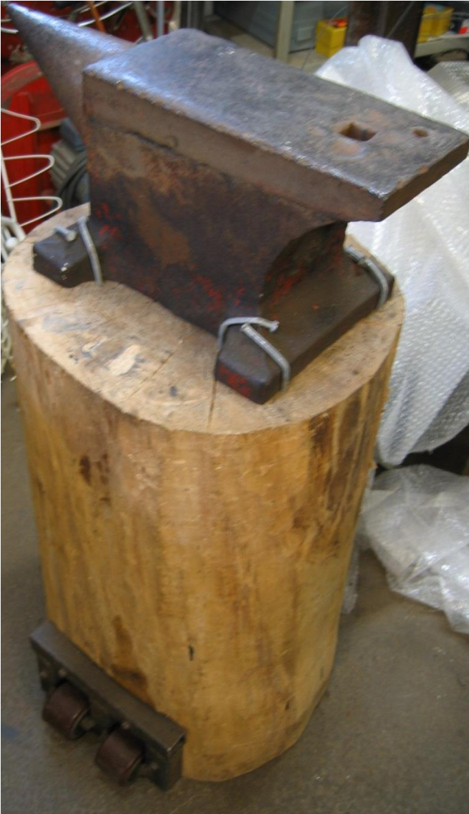
Kuva 17. Alasin: Alasimena toimii vanha, pyörillä liikutettava suuri alasin. Liikutettavuus on tärkeää, koska tällöin alasinta voi hyödyntää myös muualla kuin takomo-osastolla. [18]
