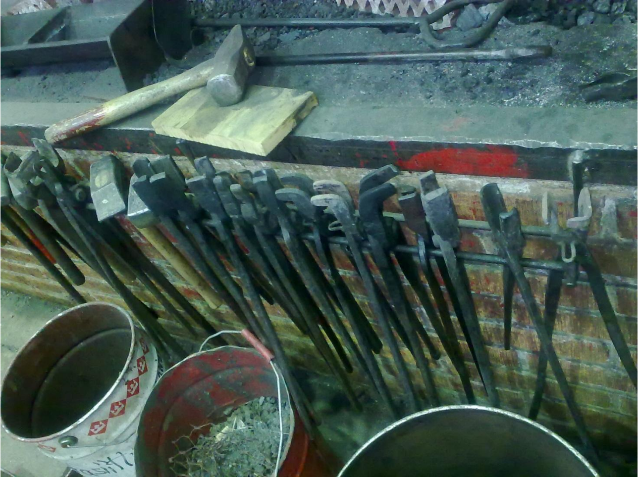
Kuva 20. Kaikki muut takomon tarvikkeet säilytetään pajan nurkan läheisyydessä pöydän alapuolella olevalla hyllytasolla. Kuvassa on sepän pihtilajitelma. [15]
