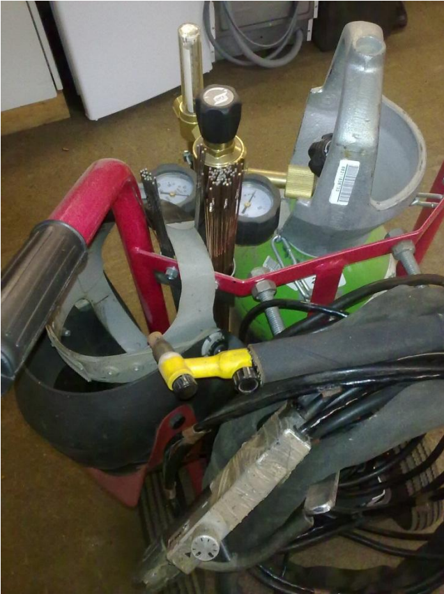
Kuva 4. Puikkohitsauslaitteisto on TIG-hitsauslaitteiston yhteydessä. [18]
