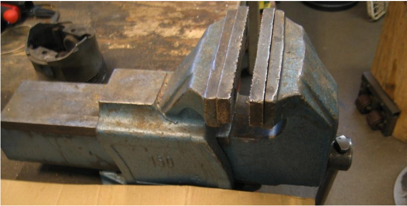
Kuva 12. Ruuvipenkki: Jokaiseen pitkään, ns. kokoamis-/ käsittelypöytään tulee ainakin yksi keski-kokoinen ruuvipenkki. materiaalin vastaanottopuolella lisäksi ainakin yksi iso leikkauksia ajatellen ja takomon puolella pienempi tarvittaessa. [18]
