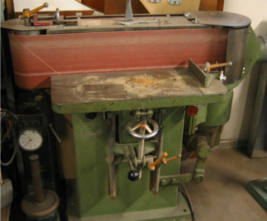
Kuva 10. Suuri nauhahiomakone: tehdaskäyttöön soveltuva, voimavirralla toimiva nauhahiomakone joka soveltuu suurempiin hioma- ja viimeistelytyöihin. [18]
