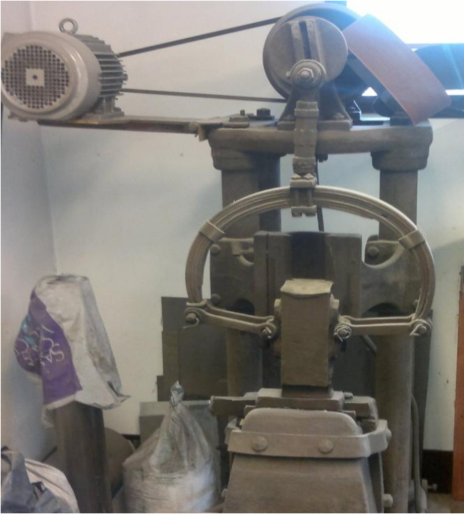
Kuva 18. Konevasara: Konevasara on pieni ja voimavirralla toimiva. [16]
