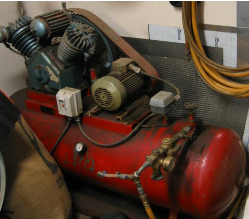
Kuva 13. Paineilmakompressori: Tehdaskokoinen ja voimavirralla toimiva. Kokonsa ja tehonsa ansiosta sillä pystyy tekemään raskaimpiakin paineilmatöitä useassa pisteessä yhtä aikaa. [18]
