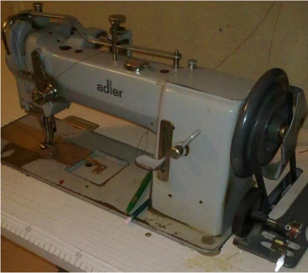
Kuva 25. Nahkaompelukone: voimavirralla toimiva vanha nahkaompelukone Adler. [17]
