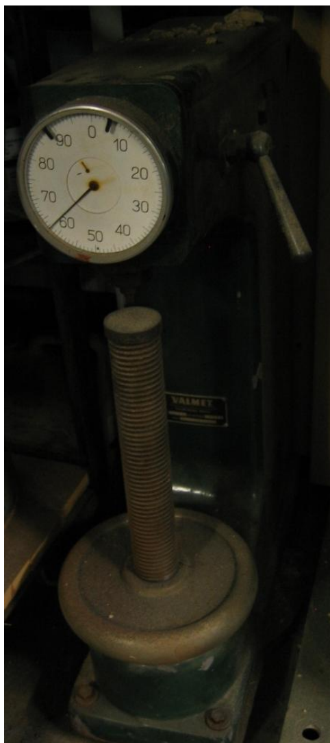
Kuva 21. Kovuusmittari: Suurikokoinen ja vanha kovuusmittari, jolla mitataan taotun teräksen/terän kovuus. Se kuuluu ahjon lähelle, koska sillä tarkistetaan puukon terän kovuus karkaisun ja päästön jälkeen. [18]
