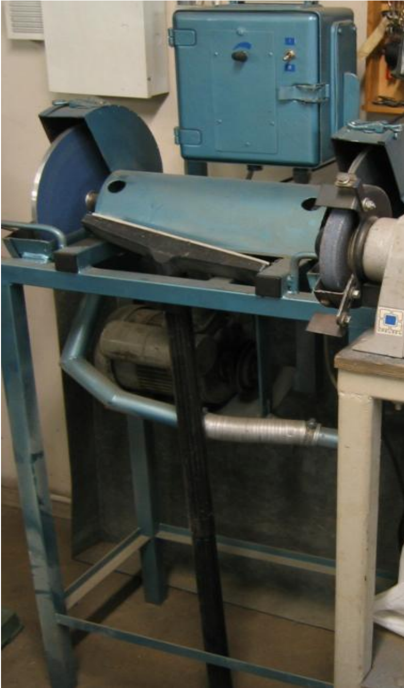
Kuva 22. Puukkojen teroitukseen rakennettu penkkihiomakone, jossa pyörii karkeudeltaan erilaiset hiomalaikat. Laite toimii verkkovirralla. [18]
