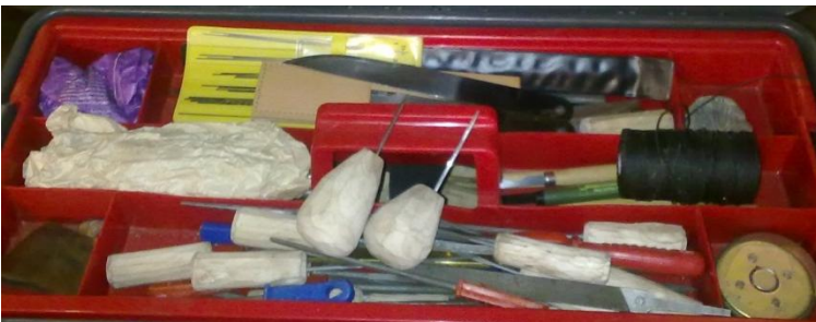
Kuva 26. Kuvassa näkyy muita nahkankäsittelyvälineitä kuten naskalit, neulat, langat ja suutarin veitset. [18]
