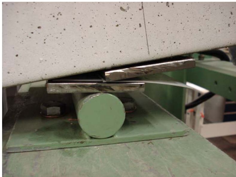
Kuva 2. Tuki B murtoon kuormittamisen jälkeen.
