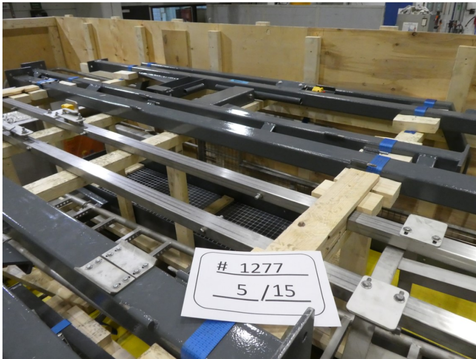
Kuva 7. Huoltotasot ja vapaa pään kakkukouru - pakkauksen päällikerros (Outotec, 2020a).
