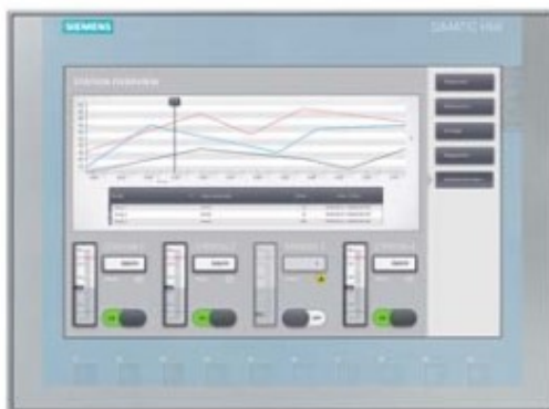
Kuva 16. KTP 1200 Basic -kosketusnäyttöpaneeli (Siemensin www-sivut 2020.)
