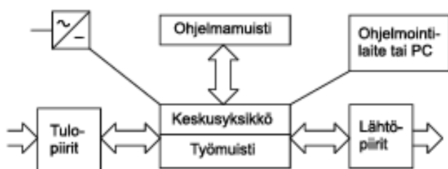
Kuva 7. PLC-laitteiston elementit (Keinänen ym. 2009, 225)
