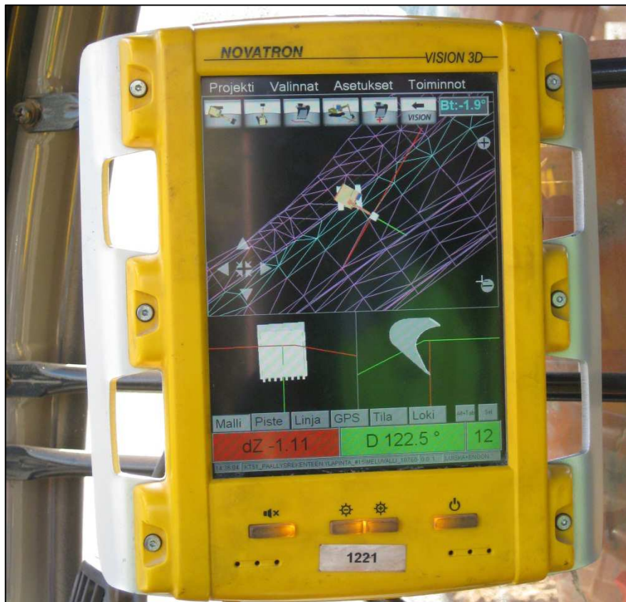
Kuva 1. Kuva koneohjausjärjestelmällä varustetun kaivinkoneen hytistä.
