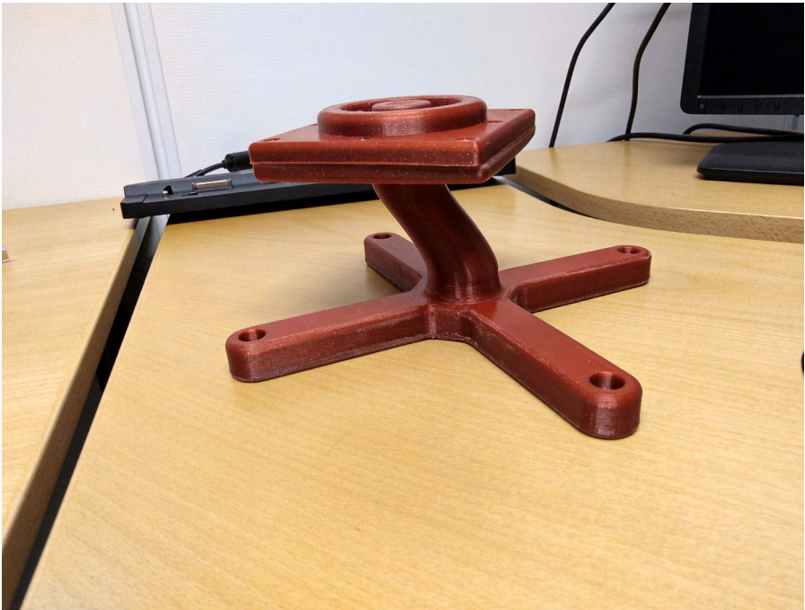
Kuva 9. 3D-tulostettu imukuppitarttujan runko V1.
