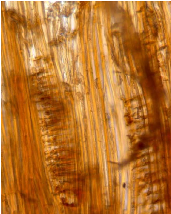
Kuva 37. Näytteen tangentialisesta leikkauspinnasta otettu mikroskooppikuva, 40 x suurennos (Artoma 2011).
