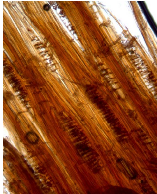
Kuva 38. Näytteen tangentialisesta leikkauspinnasta otettu mikroskooppikuva, 20 x suurennos (Artoma 2011).
