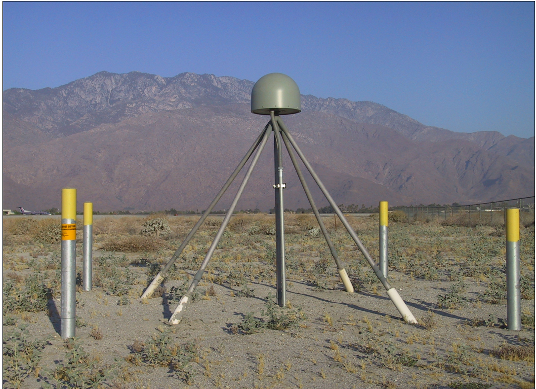
Kuva 16. Syväälle poraamalla tuettu antennialusta (UNAVCO Facility 2009).
