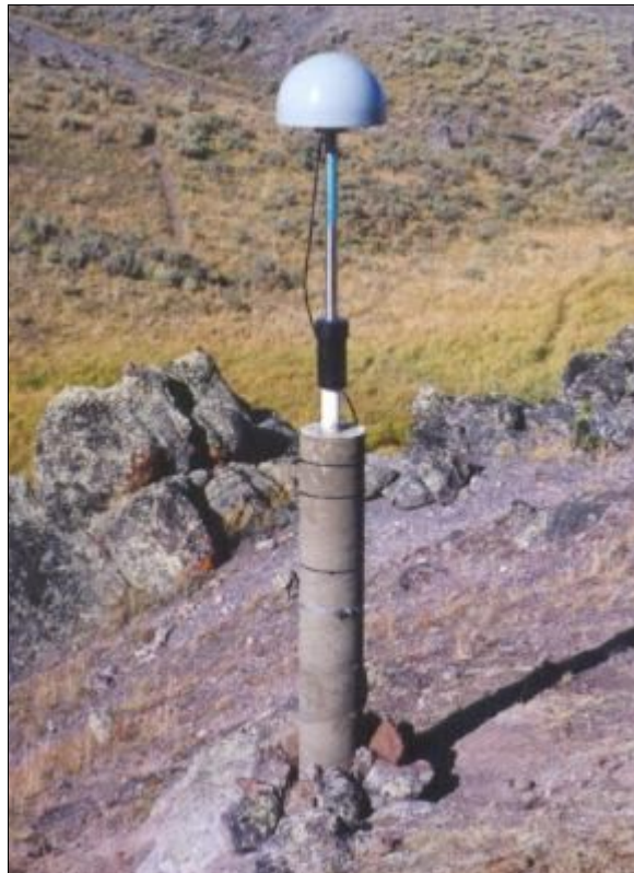
Kuva 26. Betonikoteloitu invartankomasto Yellowtonnessa (Dzurisin 1999).
