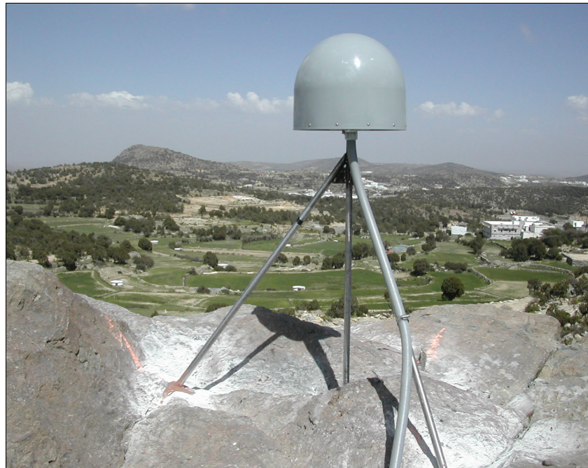
Kuva 34. Esimerkki hyvästä havaintoasemapaikasta ja SDBM:lle sopivasta kohteesta. Ehjä kallio, vapaa horisontti, eikä signaalien kulkuun vaikuttavia rakennelmia ole näkyvissä. Kuvan suojakupu on SCIGN Tall Radome. (UNAVCO Facility.)
