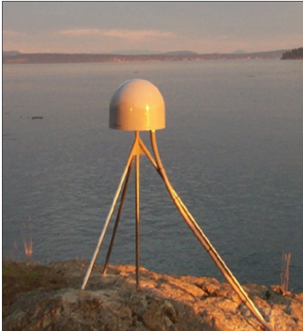
Kuva 19. Matalalle poraamalla tuettu antennialusta (UNAVCO 2009).
