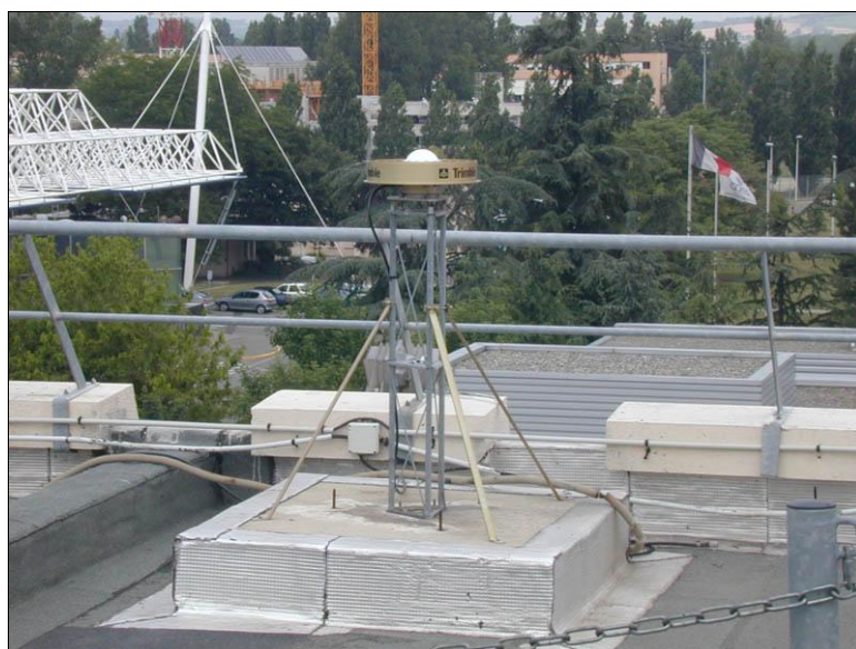
Kuva 14. Esimerkki huonosta asemapaikasta. Antennin ympäristössä on paljon monitieheijastavia pintoja ja metallirakenteita. (IGS Station: tlse.)
