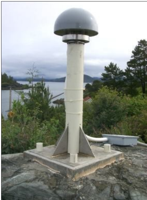
Kuva 24. WCDA:n putkimainen teräsmasto (Schmidt ym. 2000).
