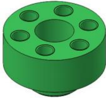
KUVA 13. Syöttöruuvien suoja putken yläosa
