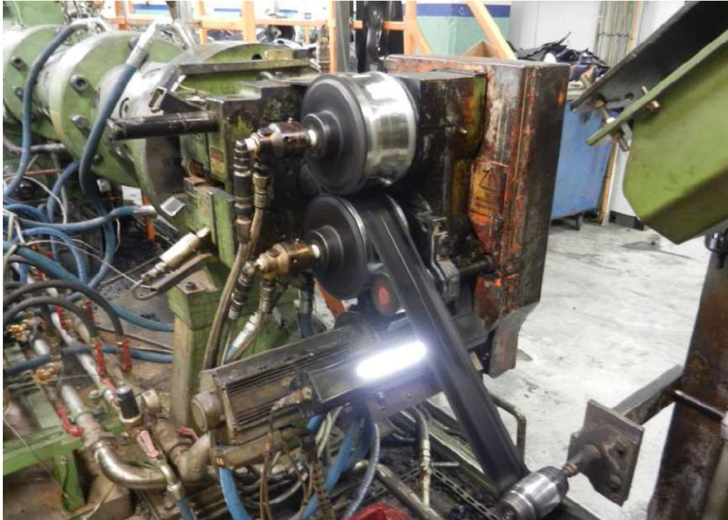
Kuvio 13, SW- käärintäkoneikon rullamuotoilija eli rollaformeri ja nauhan leveydensäätökamera
