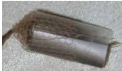
Kuva 19. Tylliverkkoputken yläreuna on kiristetty helmen yläpuolelle. (Parkkinen)
