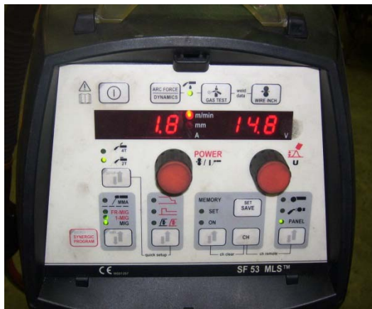
Kuva 20. Nykyaikaisissa hitsausvirtalähteissä on hitsauksen aikaisten parametrien valvontaa helpottavat mittalaitteet (Peltola 2011).
