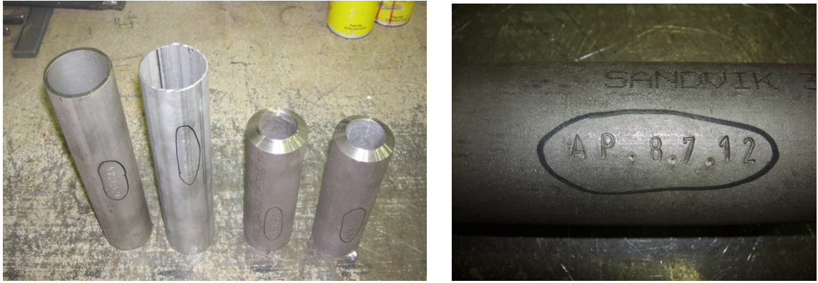
Kuva 18. Hitsaajan pätevyyskokeet hitsataan ns. tunnistetulle materiaalille. Koepalaan "pysyvästi" merkityn tunnuksen perusteella on löydettävissä teräksen valmistajan ilmoittama sulatusnumero ja materiaalidistus (Peltola 2011).
