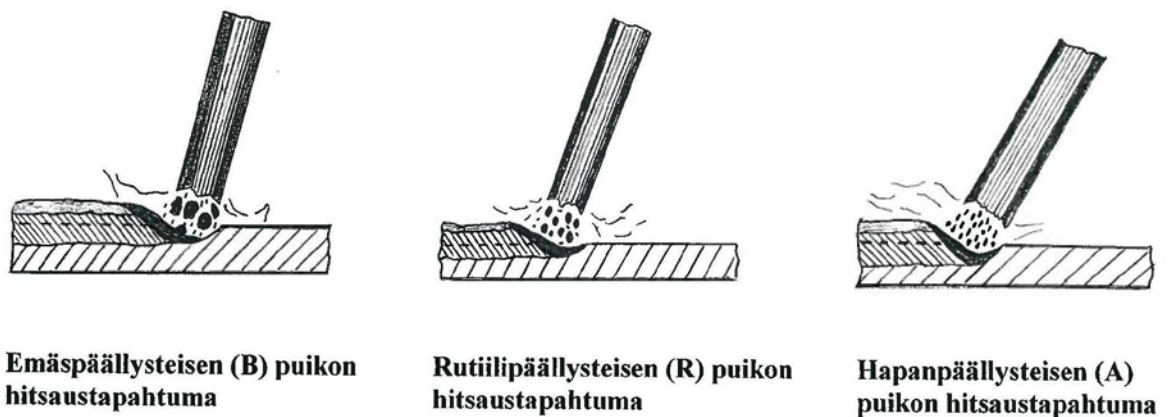
Kuva 28. Hitsauspuikon päällysteen vaikutus hitsiaineen siirtymisessä (Peltola 2011).
