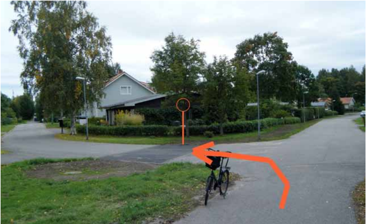
Kuva 13. Yhdistetty kevyenliikenteenväylä jatkuu nuolen osoittamaan suuntaan. Kuva osoittamassa kohdassa olisi hyvä olla yhdistetyn kevyenliikenteenväylä liikennemerkki.
