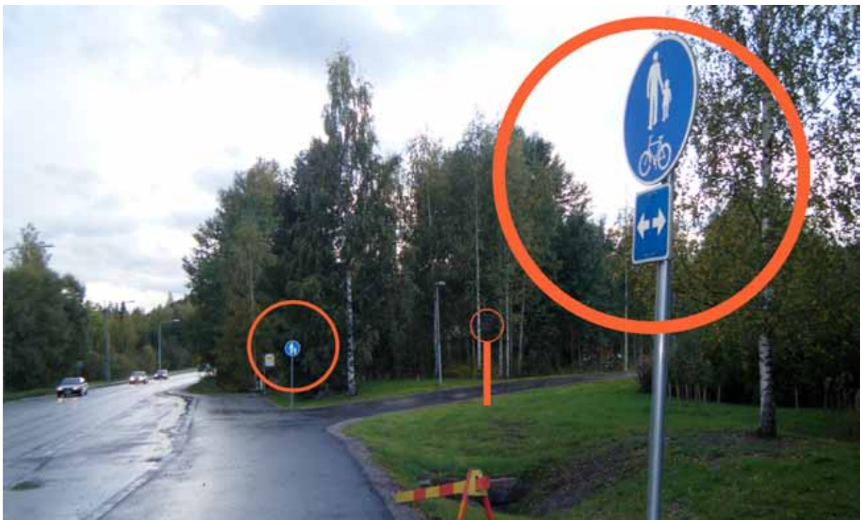
Kuva 86. Kuvan osoittamassa kohdassa olisi hyvä olla yhdistetty kevyenliikenteenväylän liikenne-merkki.
