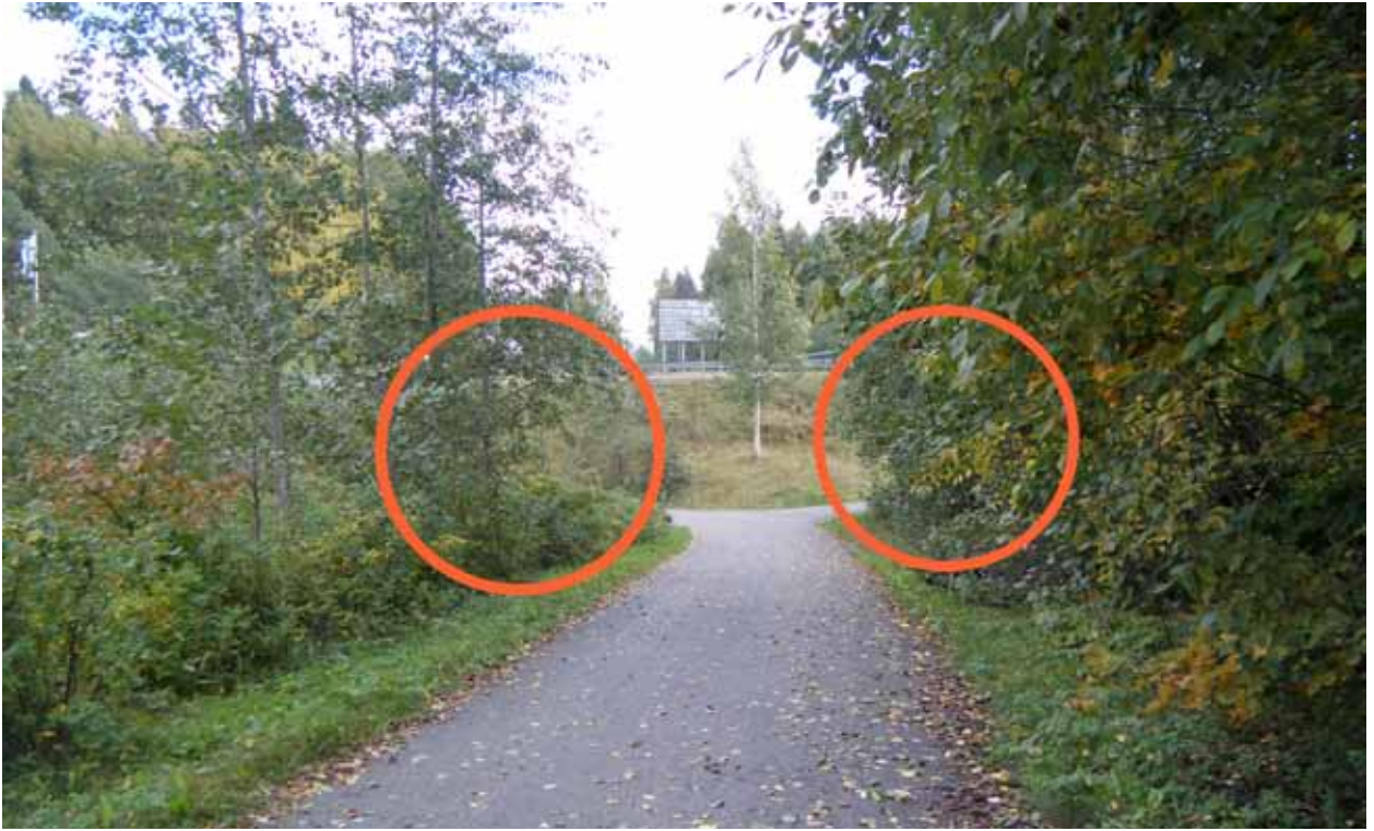
Kuva 69. Alikulkutunneleiden suuaukkojen edessä oleva kasvillisuus peittää näkemäalueen.
