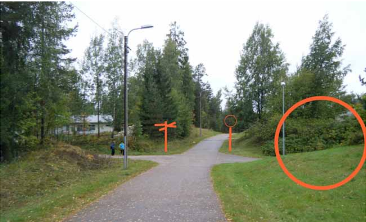
Kuva 28. Kuva osoittamassa kohdassa olisi hyvä olla yhdistetyn kevyenliikenteenväylä liikennemerkki ja opastetolppa. Alikulkutunnelin suuaukon edessä oleva kasvillisuus peittää näkemäalueen.
