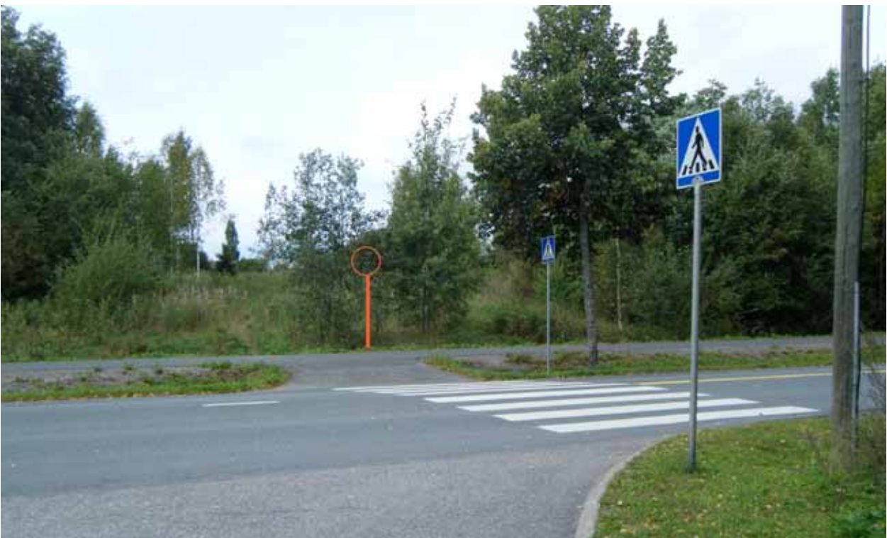
Kuva 8. Kuva osoittamassa kohdassa olisi hyvä olla yhdistetyn kevyenliikenteenväylän merkintä.
