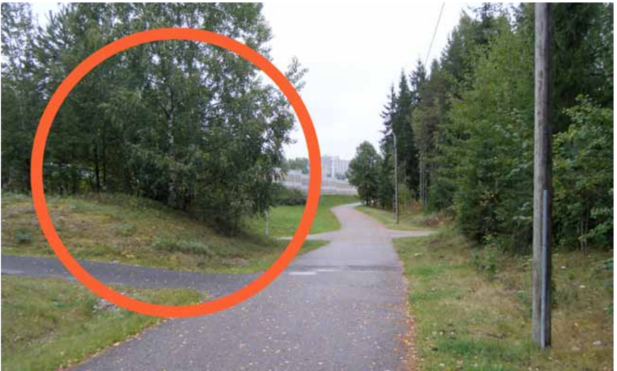
Kuva 30. Alikulkutunnelin suuaukon edessä oleva kasvillisuus peittää näkemäalueen.
