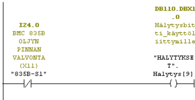
Kuva 32 Öljypinnanvalvontahälytyksen siirto logiikkaohjelmassa
