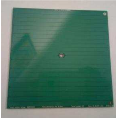
Kuva 26. Lämmitettävän tulostuspöydän lämmityselementti.
