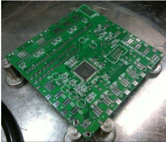
Kuva 29. Ensimmäinen piirilevyversio valmiina komponenttien käsiladontaan.
