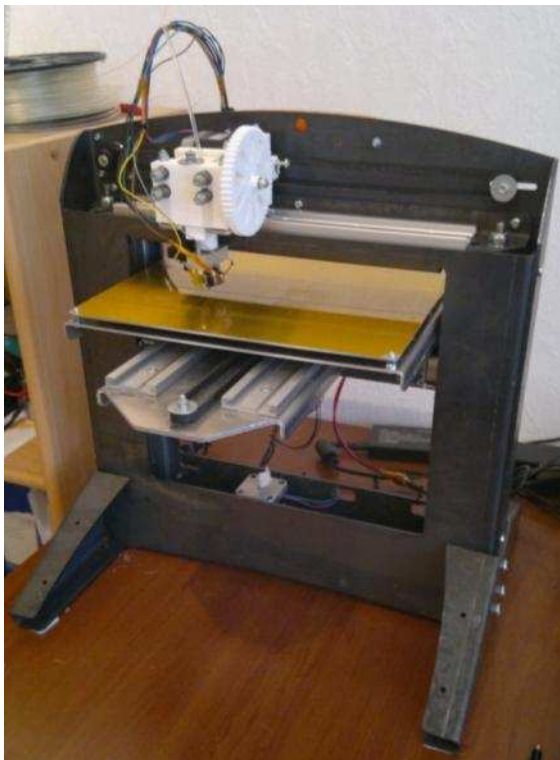
Kuva 27. 3D-tulostimen prototyyppi valmiina testeihin.
