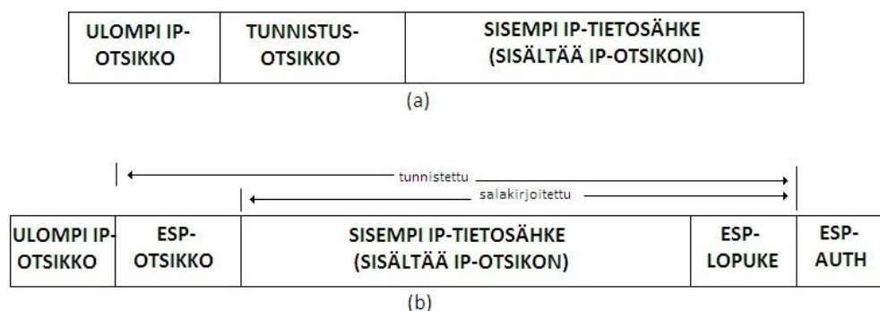
Kuva 8. IPsec –tunnelointi [RFC 2401], ESP-osa (b) [9]
