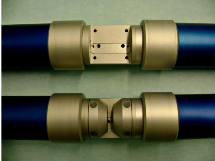
KUVIO 8. S::can-mittalaitteiden valotiet, ylempänä 35 mm:n valotie ja alempana 5 mm:n valotie
