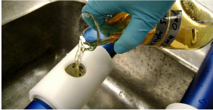
KUVIO 9. Näytteen asettelu S::can-mittalaitteeseen näytteen mittaamista varten laboratorio-oloissa
