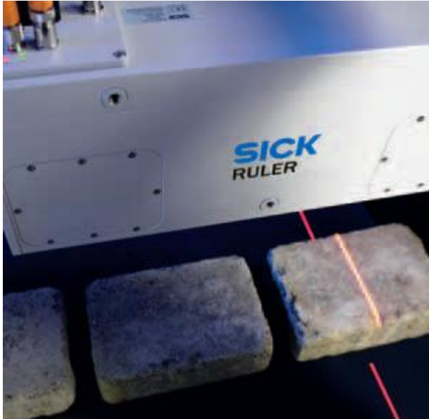
Kuvio 6. SICK Rulerin toimintaperiaate.
