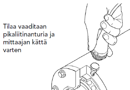
Kuva 11. Anturitaskun asentaminen moottoriin.[18]
