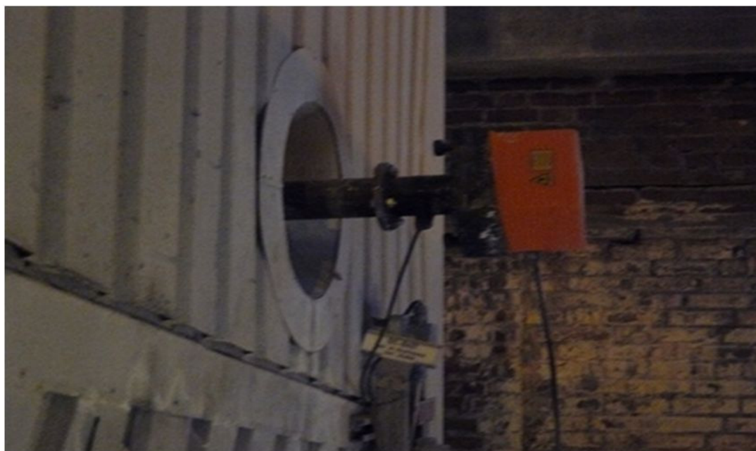
Kuva 3. Pölyn määrän mittari SP100 sähkösuodatin 7:n jälkeen
