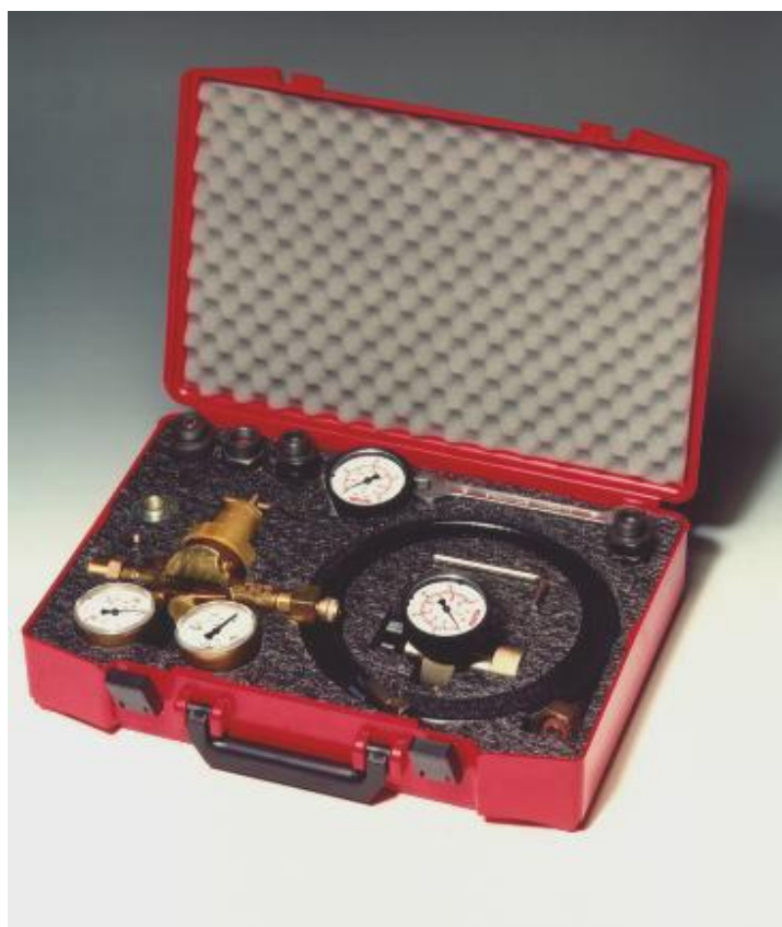
Kuva 8: Täyttö- ja tarkastuslaite FPU (Friedrich, B. 1998, Akkutekniikan perusteet materiaalia )
