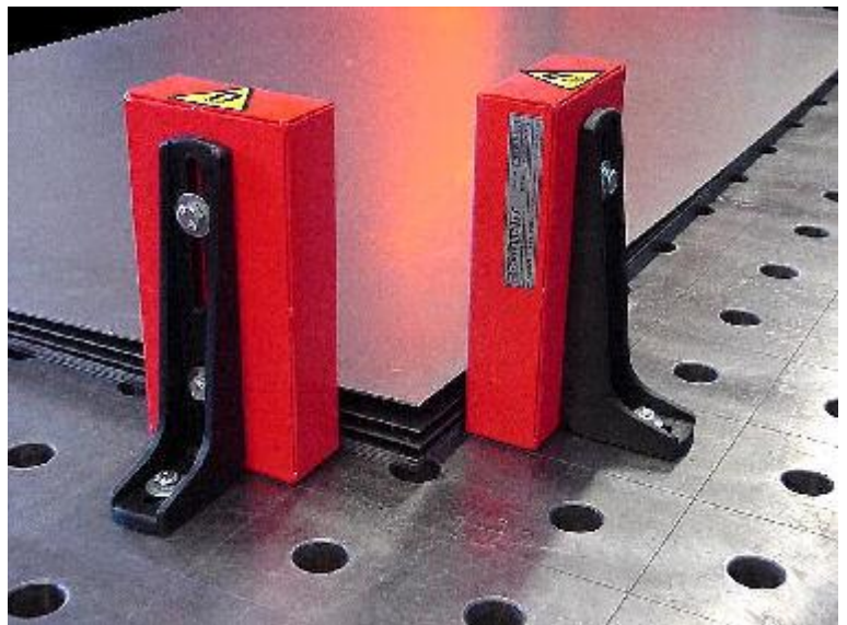
Kuvio 5. Erotusmagneetit kohottavat päällimmäisen levyn (Magnetic sheet separators [Viitattu 1.12.2011].)
