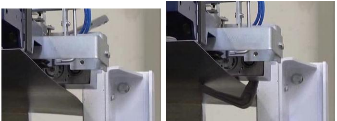
Kuvio 34. Trumpf Sheetmasterin levyn paksuuden mitta-anturi (Sheetmaster 2011.)
