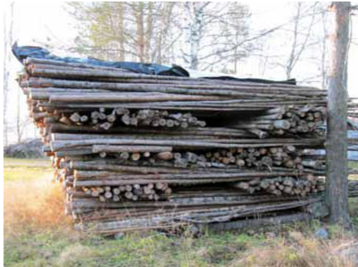
Kuva 4. Varastopino, jonka kasaamisessa on käytetty välipuita (Lepistö ym. 2010.)
