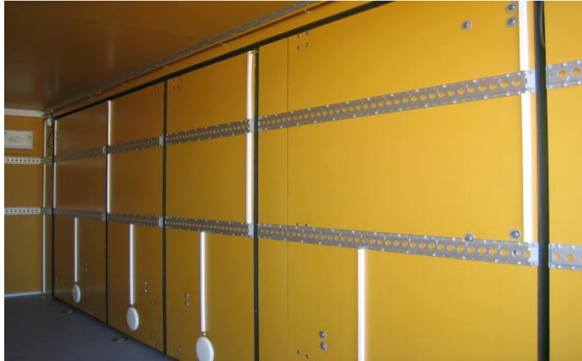
KUVA 9. Räjähdetarvikevaraston kokosivuaukeaviin oviin on kiinnitetty kuormansidontakiskot (Kuva Morehouse Oy)
