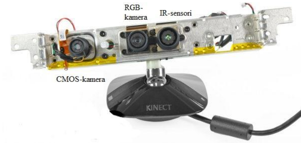
Kuva 24. Microsoft Kinect -ohjaimen rakenne. 41
