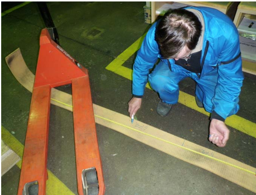
Kuva 6, Jarrunauhan suoristaminen pituuden mittausta varten
