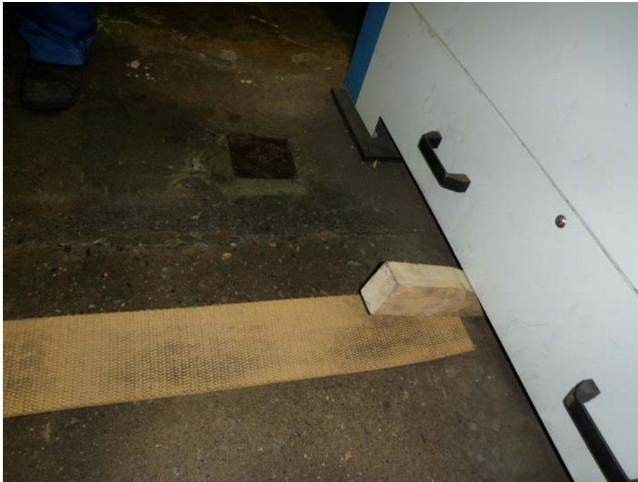
Kuva 7, Jarrunauhan pään kiinnittäminen nauhaa suoristaessa
