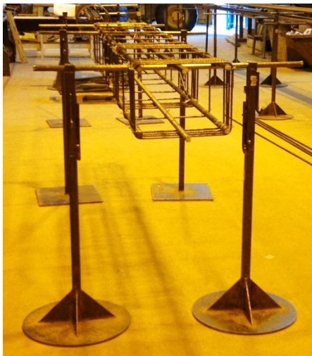
Kuva 3.5a. Raudoitepukit (vas.) Kuva 3.5b. 3D-raudoitekuva (oik.) (HRC)
