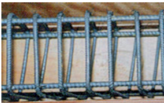
Kuva 4.3. Koneellisesti tuotettu kierrehakaraudoite (CPI 4/2010.)
