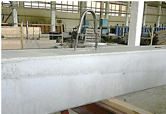
Kuva 2.8a. Perinteinen nostolenkki (vas.) Kuva 2.8b. Halfenin DEHA-ankkurijärjestelmä (oik.)
