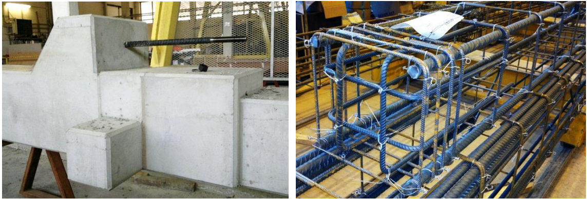
Kuva 3.2a. Pilarin konsoli ja palkin asennuspultti (vas.) Kuva 3.2b. Pilarin pään raudoite (oik.)
