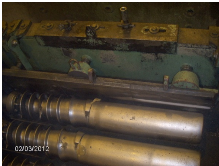
Kuva 7. Oikealla ontelolaattavalukoneen tiivistystuurna
