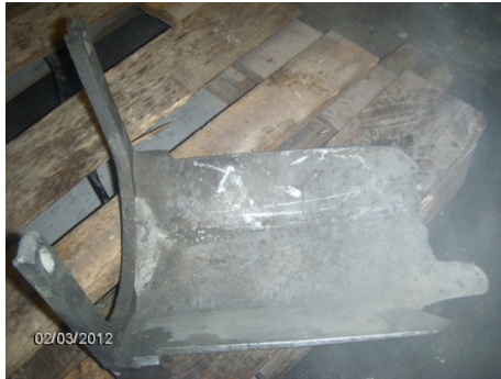
Kuva 8. Loppuun kulunut massakouru
