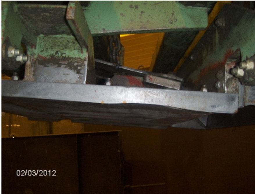
Kuva 11. Tasointuspalkiston kulutuslevyn kuluminen
