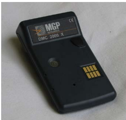
KUVA 13. MGP Instruments DMC 2000 X -dosimetri
