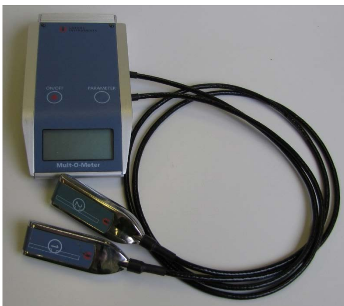
KUVA 7. Unfors Mult-O-Meter 581 -mittalaite
