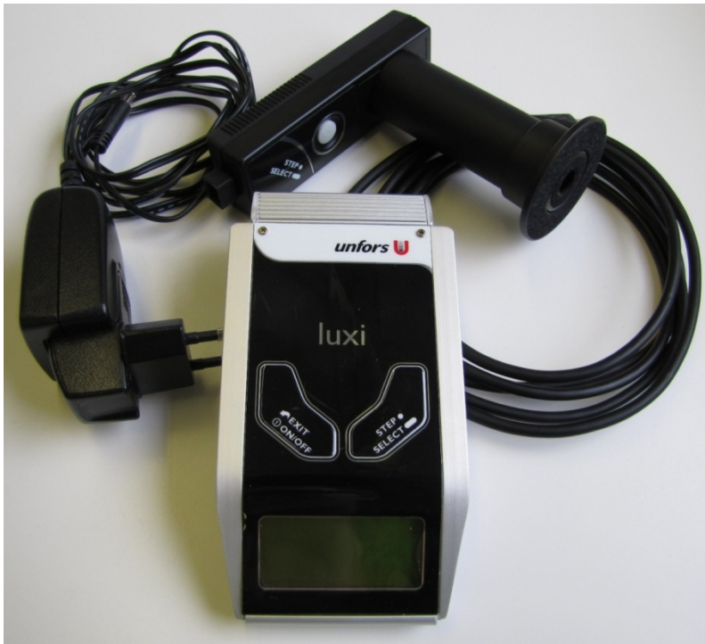
KUVA 8. Unfors Luxi -valoisuusmittari
