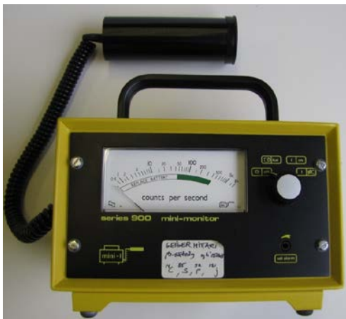
KUVA 15. Mini-Instruments Mini Monitor Series 900 Type E -säteilynlmaisain
