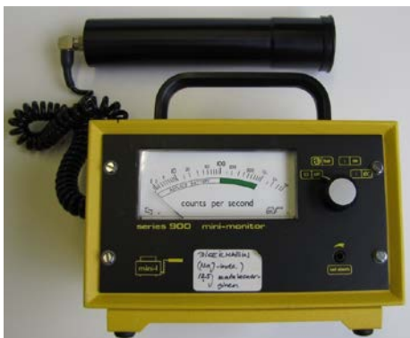
KUVA 16. Mini-Instruments Mini Monitor Series 900 Type 42A -säteilynlmaisain
