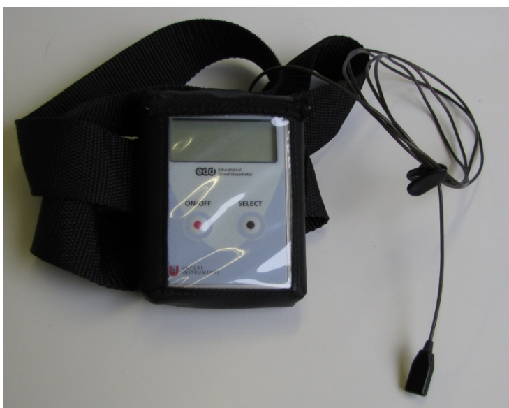
KUVA 9. Unfors EDD-30 -mittalaite
