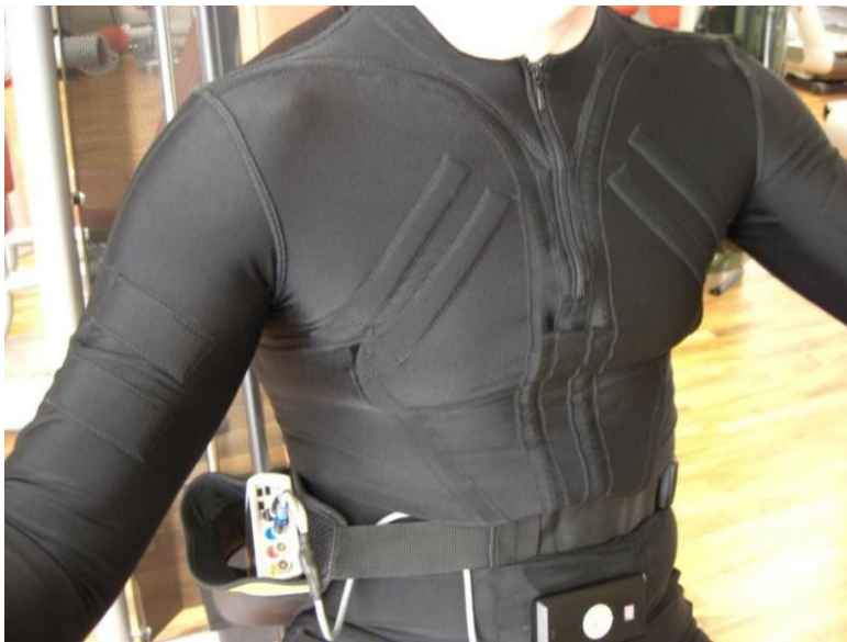
Kuva 2: Biosignaaleja mittaava anturipaita
