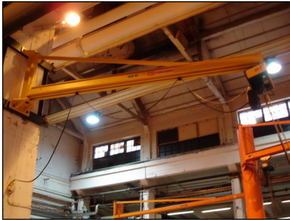
Kuva 7. Nostopuomi, kapasiteetti 1 t.
