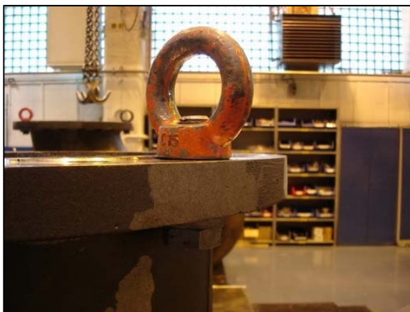
Kuva 8. Nostosilmukka pumpun laippaan kiinnitettynä.
