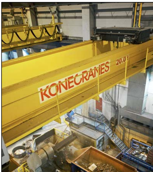
Kuva 6. Teollisuusnosturi, kapasiteetti 20 t (9).
