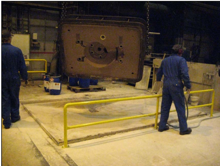
Kuva 28. Muotin siirto peitostuspaikalle.
