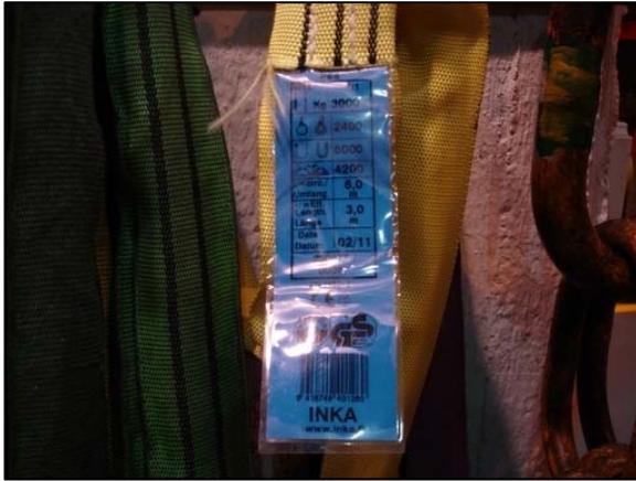
Kuva 3. Päälysteraksin lappu, joka osoittaa muun muassa enimmäiskuormituksen ja pituuden.
