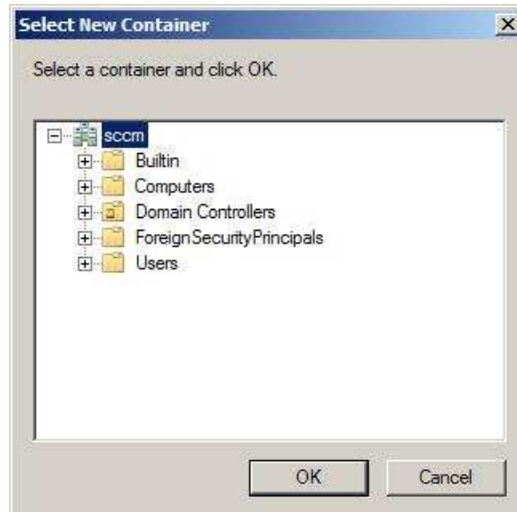
Kuva 16. Select New Container -laatikosta valitaan säilö, josta objekteja etsitään.
