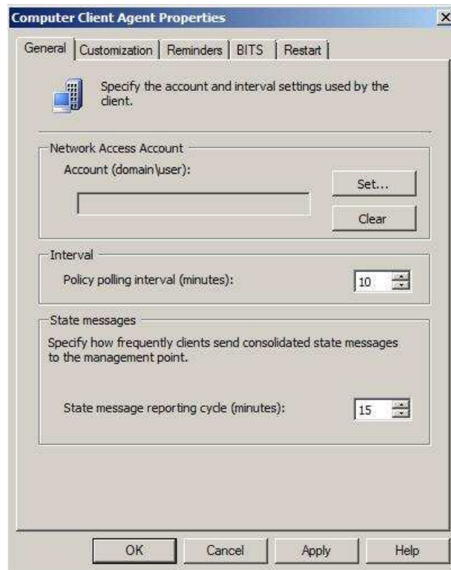
Kuva 23. Computer Client Agent Properties -laatikossa voi tehdä yleisiä client-koneita koskevia asetuksia.
