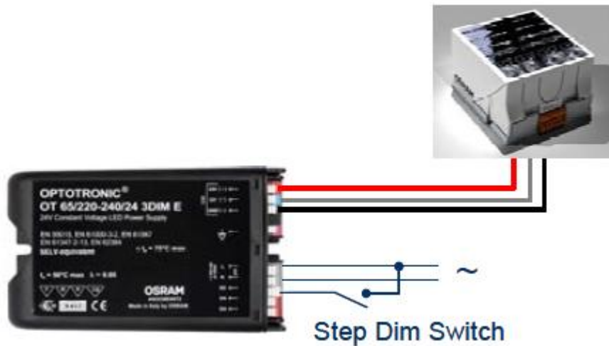
KUVIO 16. Osram StepDIM -kytkentä (Osram 3DIM 2012)
