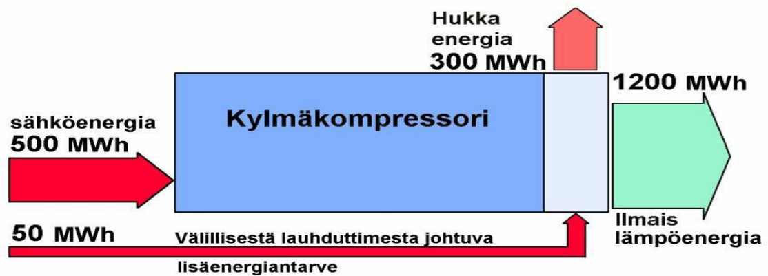
Kuva 13. Lauhde-energian hyödyntäminen edellyttää kompressorin välillistä lauhdutinta [6]
