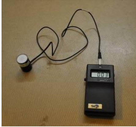
Kuva 17. PAR- mittari, jolla mitattiin valon intensiteettiä (Hellgrén 2011).
