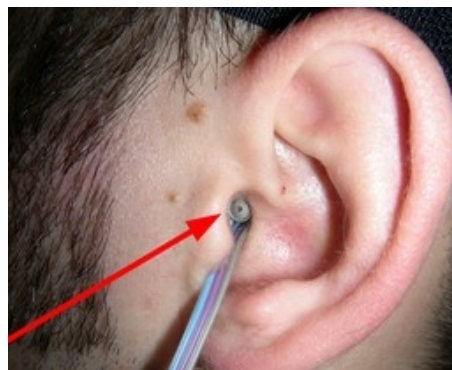
KUVA 5. Sennheiser KE 4-211-2 -elektreettimikrofoni asetettuna korvakäytävään. (lähde: http://www.kfs.oeaw.ac.at/research/experimental_audiology/hrtf/inearmic.jpg )
