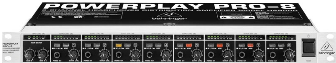
KUVA 2. Esimerkki tyypillisestä edullisen hintaluokan kuulokevahvistimesta, jossa on kahdeksan kanavaa: Behringer Powerplay Pro-8 HA8000
