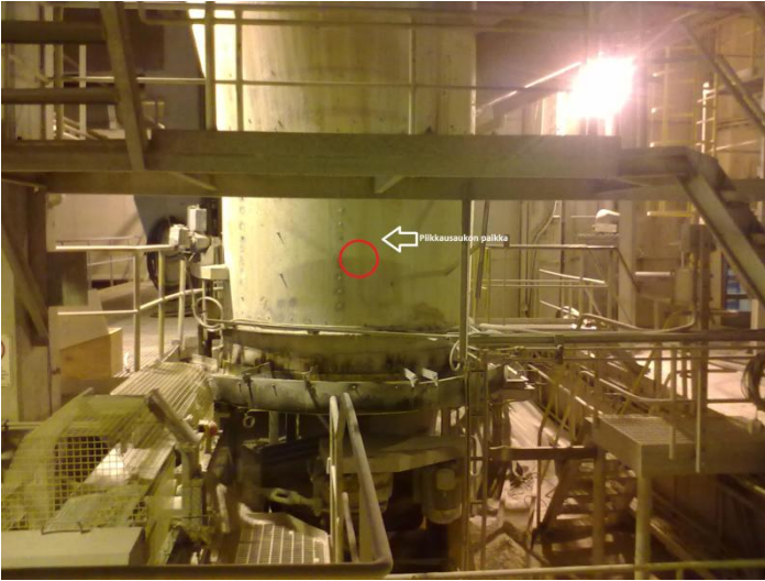
KUVA 14. Piikkausaukon paikka lautassyöttimellä 401. (kuva Anssi Hakkarainen)
