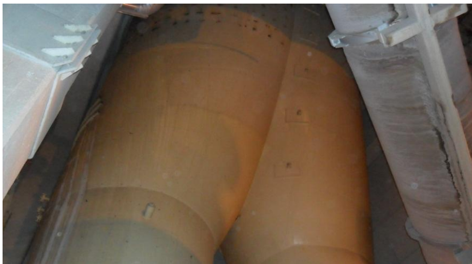
KUVA 8. Apatiittisiilo yhdistymiskohta. (valokuva Anssi Hakkarainen)
