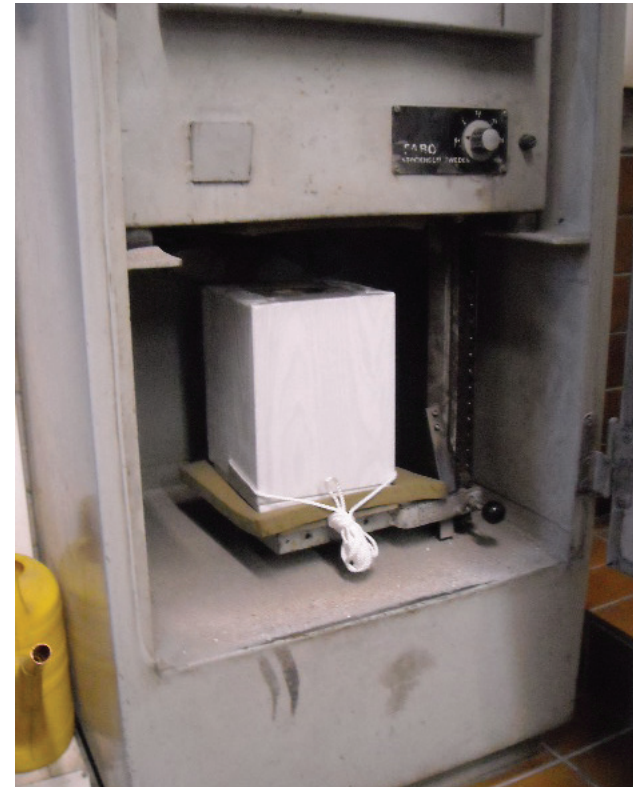
Kuva 8. Hietaniemen krematorion tuhkankäsittelykone (Tilkanen 2012).
